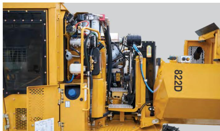
Accès facile aux filtres hydrauliques, aux pompes à huile hydrauliques, au niveau d'huile du boîtier d'entraînement, à la pompe à injection du FED et au réservoir du FED.
