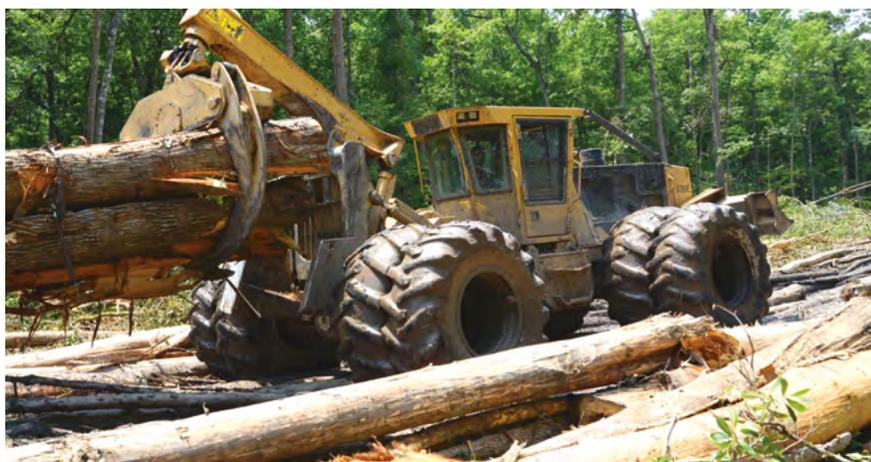
Tous les modèles de la série E sont équipés de pneus jumelés ou de pneus de flottaison.
