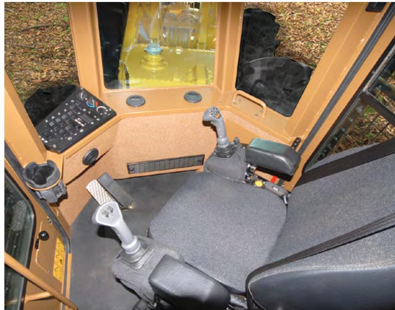
LE SIÈGE PIVOTANT TURNAROUND À DEUX POSITIONS EST UN ÉQUIPEMENT STANDARD DE TOUS NOS DÉBARDEURS.
