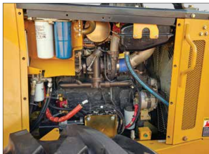
Compartiment moteur propre et compact avec accès rapide aux points d'entretien quotidiens.
