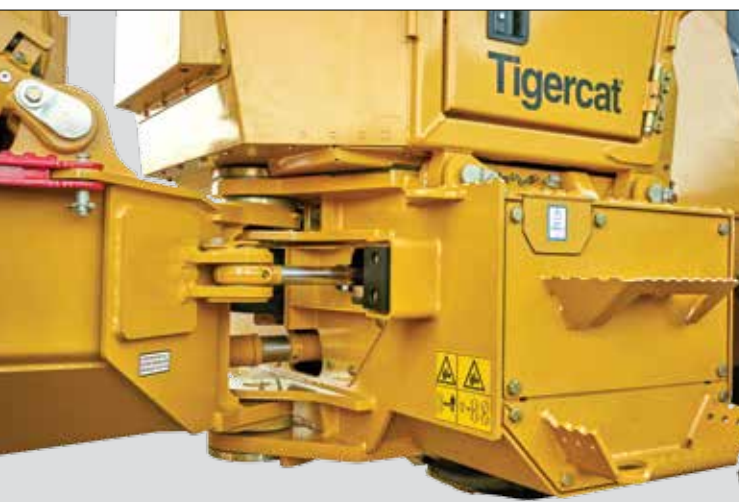
Robuste section centrale avec de grands axes et roulements à rouleaux coniques.
