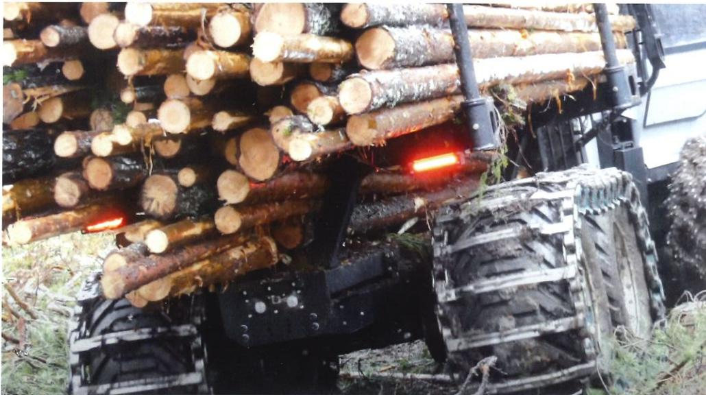
Vimek 870.1 NG verfügt über ein DSS (Dual Steering System), d.h. die Lenkung erfolgt sowohl im Mittelgelenk als auch im hinteren Bogie. Dies reduziert den Platzbedarf für den Betrieb des Vimek 870.1 NG auf engstem Raum.
